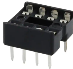
U3-SCKT, U4-SCKT: 8 Pin DIP IC Sockets
